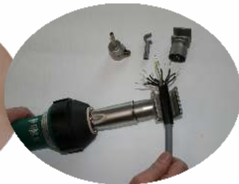
Smršťování spojení kabelů v automobilu.
